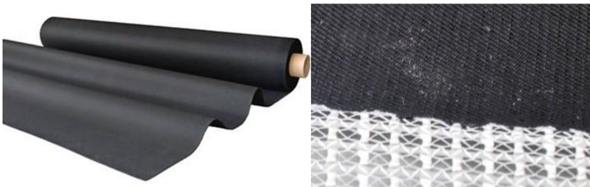
Abbildung 26 Durch kontinuierliche Vulkanisation (Rotocure) hergestellte Bahnenware Links: Bahnbreite 1,25 Meter, Dicke 2 mm. Reißfestigkeit: 16 MPa, Dehnung; 440 % Rechts: Bahnbreite 1,25 m, Dicke 0,6 mm, mit Textilarmierung
