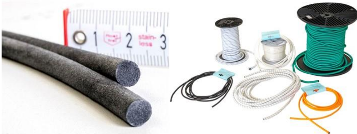
Abbildung 25 Links: Durch Profilextrusion hergestellte Rundschnüre (Durchmesser 6 mm) Rechts: Daraus hergestellte Gummiseile mit verschiedener Ummantelung
